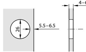
Possibilidade de Ajuste: Ajuste lateral de -0,5 a +5,5mm
