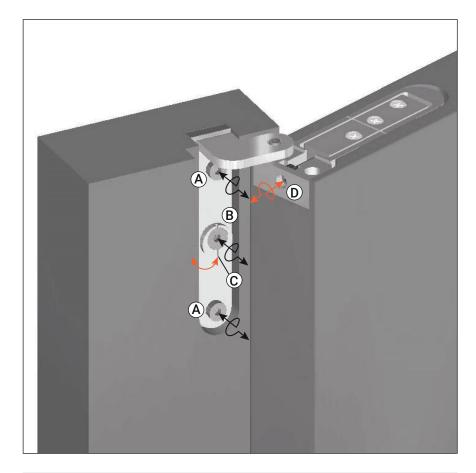
Solte os parafusos A e B e atue no C excêntrico para ajustar a profundidade
